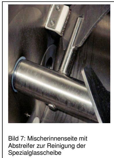
Bild 7: Mischerinnenseite mit Abstreifer zur Reinigung der Spezialglasscheibe
