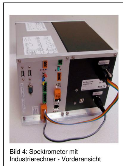
Bild 4: Spektrometer mit Industrierechner - Vorderansicht
