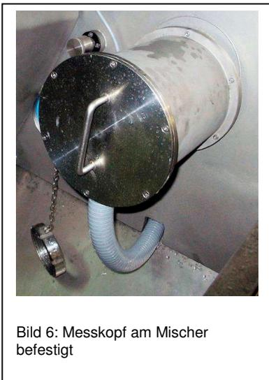
Bild 6: Messkopf am Mischer befestigt
