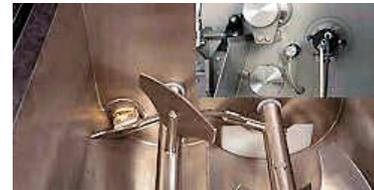
Bild 3: Messsonde im Mischer
